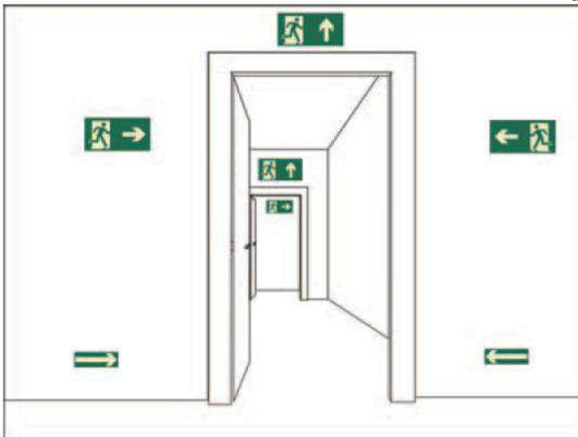
Sinalização de saída sobre paredes e vergas de portas
